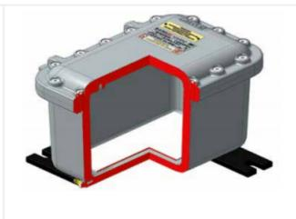
Оболочка, фланец крышки и корпус которой образуют плоское взрывонепроницаемое соединение (плоскую взрывонепроницаемую поверхность). Крепление крышки к корпусу осуществляется с помощью винтов. В отличие от оболочек ЈВ, данные оболочки прошли дополнительные испытания для применения во взрывоопасных средах IIC (кроме ацетилена).
