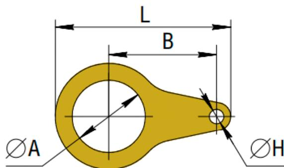
Габаритные размеры колец заземления серии Y
