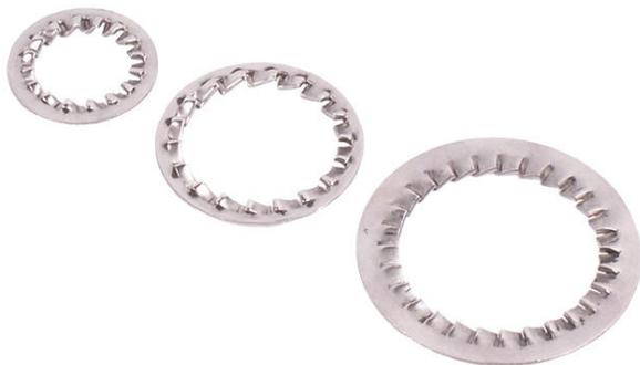
Рифленые шайбы предназначены для предотвращения самоотвинчивания кабельных вводов в оборудовании, подверженном вибрации при нормальных режимах эксплуатации.
