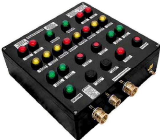
Для проектирования постов управления серии МС применяется множество элементов управления и индикации. В сочетании с коммутационной контактной группой элемент управления образует функциональную группу. Например, кнопка «Пуск» реализуется путем сочетания элемента управления «нажимная кнопка» и контактной группы с нормально разомкнутым контактом (контактами).
